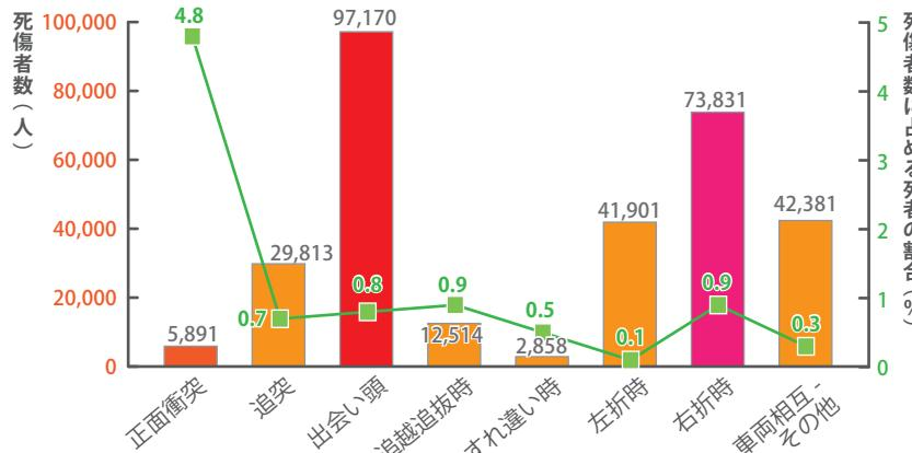
図1：二輪車対四輪車の車両相互事故の事故類型別死傷者数と死者の割合
